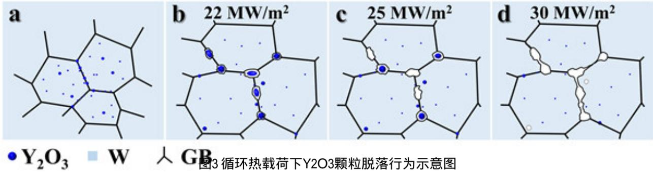
图3 循环热载荷下Y<sub>2</sub>O<sub>3</sub>颗粒脱落行为示意图
