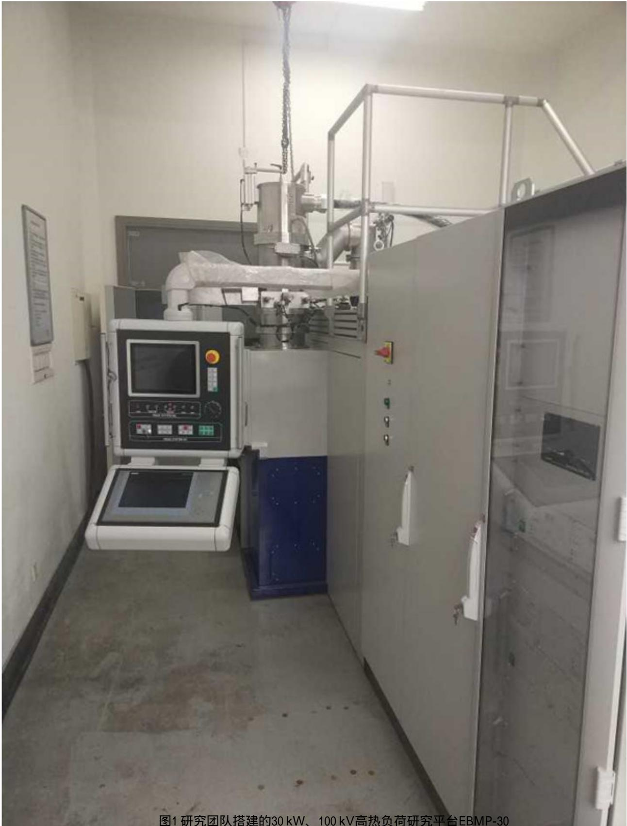
图1 研究团队搭建的30 kW、100 kV高热负荷研究平台EBMP-30
