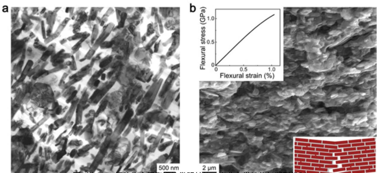
图1. 镁-MAX相仿生金属陶瓷的微观结构、弯曲力学性能与断裂机制
