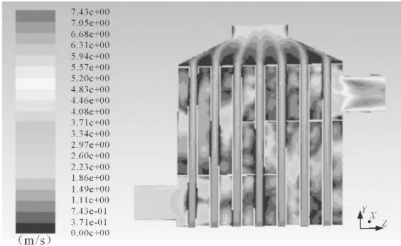
图 14 优化后换热器纵截面速度云图
