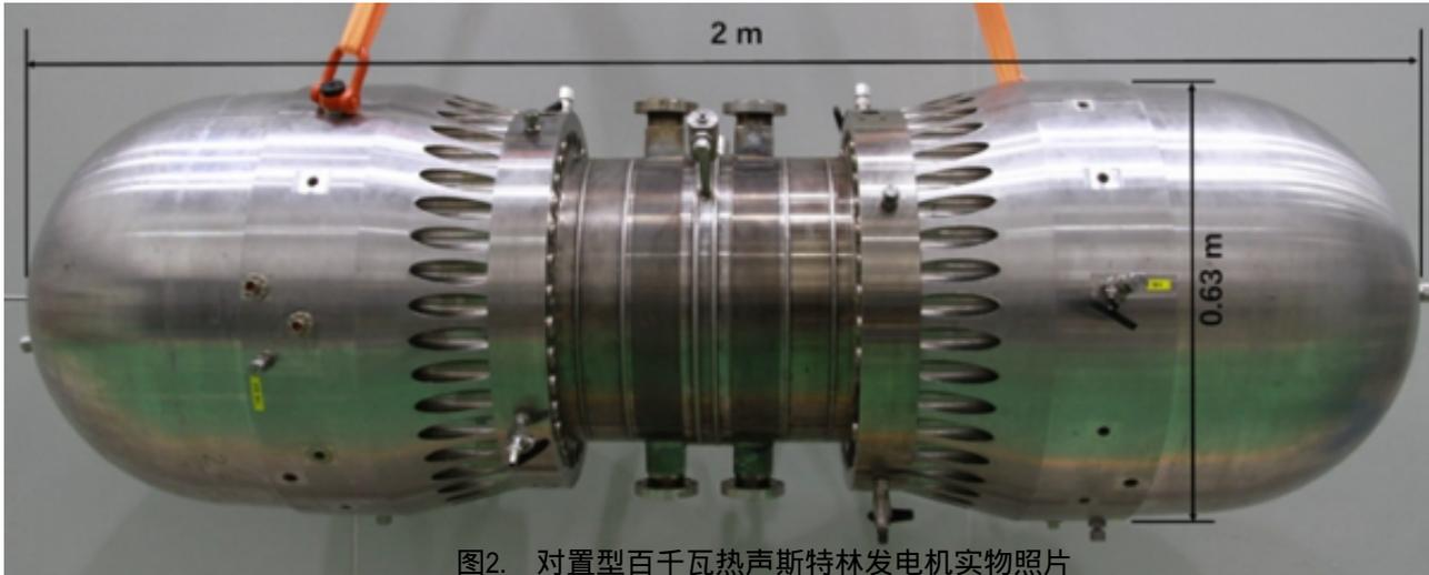
图2. 对置型百千瓦热声斯特林发电机实物照片
