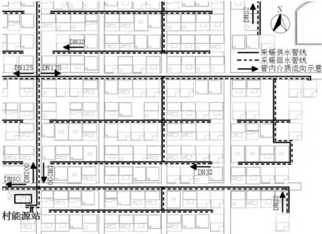
b. 村东南部供热管网平面局部示意图
