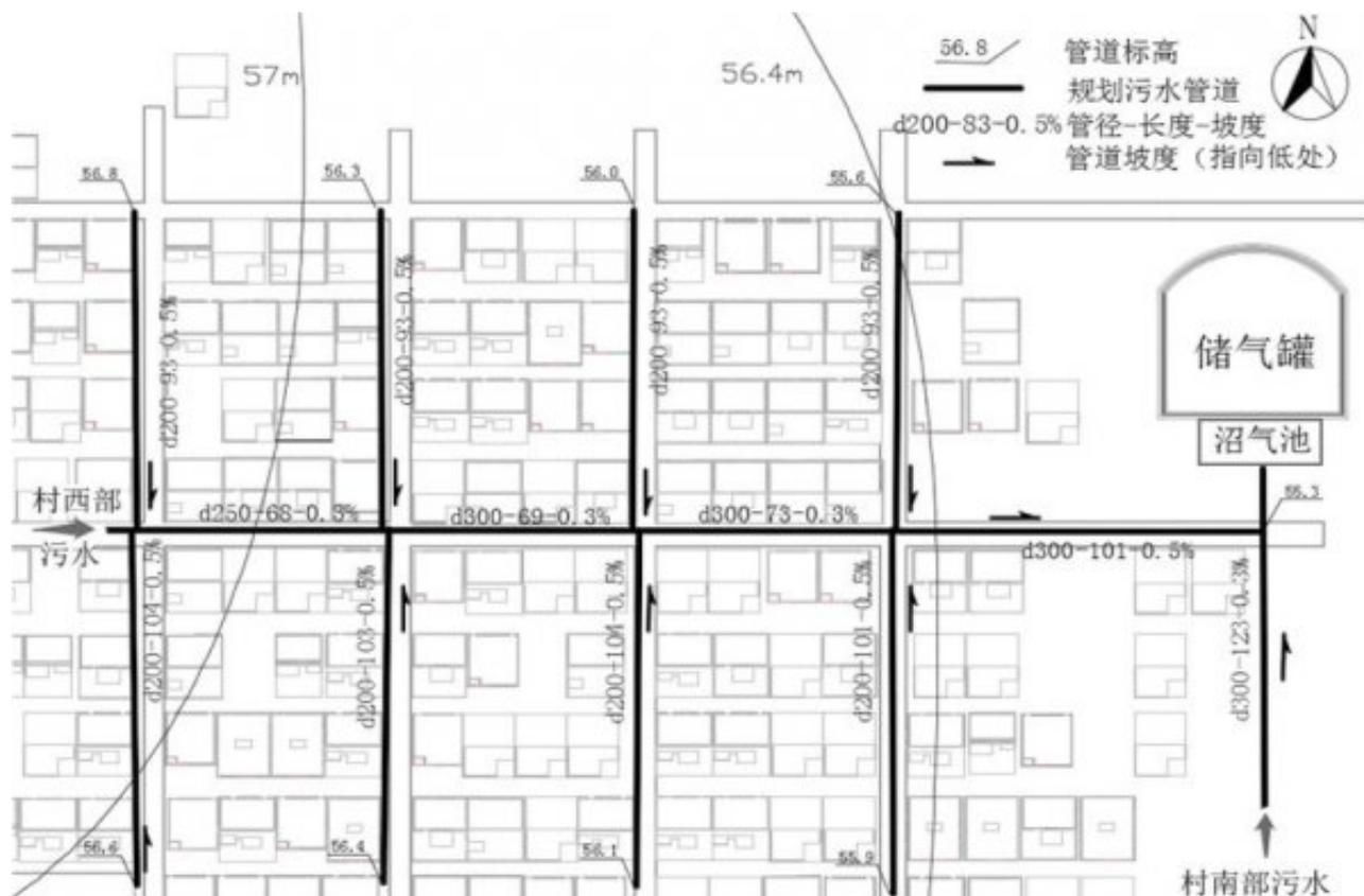
图5 该村东北部污水管网规划局部示意图
