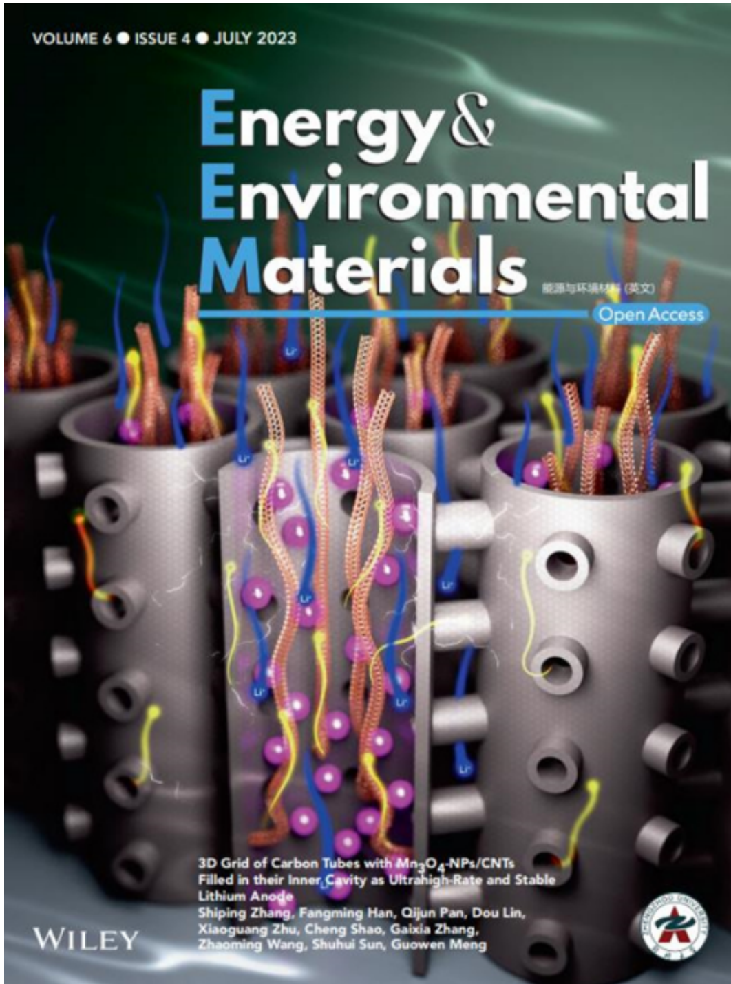
图1. Energy & Environmental Materials封面文章。基于三维互连碳管网格膜的高性能锂离子电池负极。其中，该工作在大直径的碳管内壁/腔内充填 Mn_3O_4 纳米颗粒/小直径碳纳米管CNTs。
