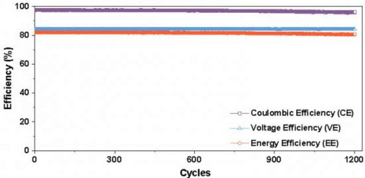
本工作中，李先锋团队采用自主开发的新一代高选择性可焊接多孔复合膜和可焊接高导电双极板，利用其可焊接特性，开发出短流程、超薄电池结构，并结合低流阻、高均匀分配流道的结构设计，研制出70kW级电堆。经测试，该电堆在70kW额定功率充放电条件下的能量效率为81.0%；在60kW恒功率充放电条件下能量效率为82.1%。此外，该电堆连续稳定运行1200多个循环后，能量效率衰减率仅为1.7%。使用该电堆，可将一个20尺的250kW储能单元模块升级为500kW储能单元模块，不仅功率单元体积大幅减小，更降低了系统配套设施的成本。该电堆的开发提升了储能系统功率单元的集成度，有望大幅提升储能系统的经济性和可靠性。
