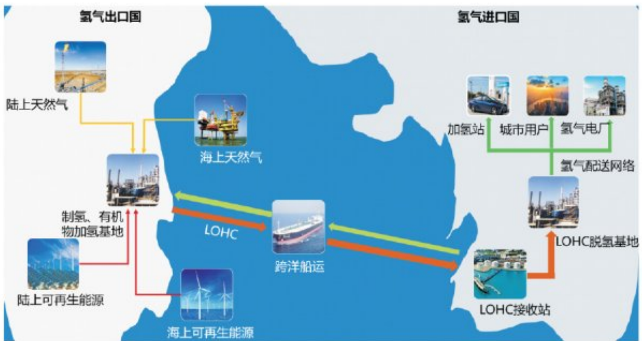
图1 基于有机物储氢技术的氢气跨洋运输与国际氢贸易
