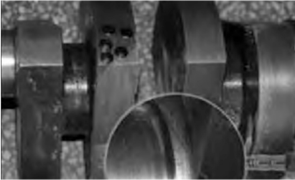
图 1 机械疲劳裂纹
