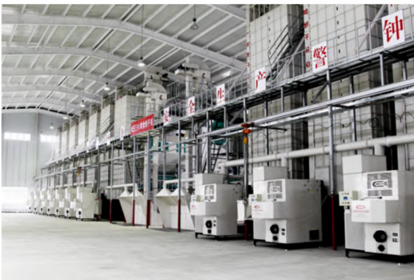
图3 生物质颗粒热风炉烘干粮食应用场景
