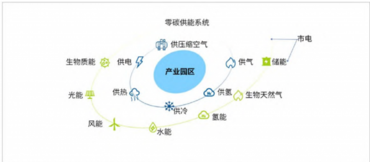
图2 零碳供能系统图
