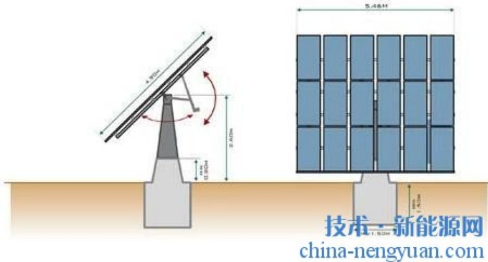
本系统使用双向方式进行跟踪、采用时间与光敏元件共同控制，可对板阵朝向进行水平 $\pm 100^\circ$ 、垂直 $5^\circ \sim 85^\circ$ 的自主调整；主体运用特殊结构增强抗风能力；系统可通过RS232与RS485接口提供运行状态参数及故障告警。经测试，采用本系统的太阳能组件可有效增加发电量30%-40%。
