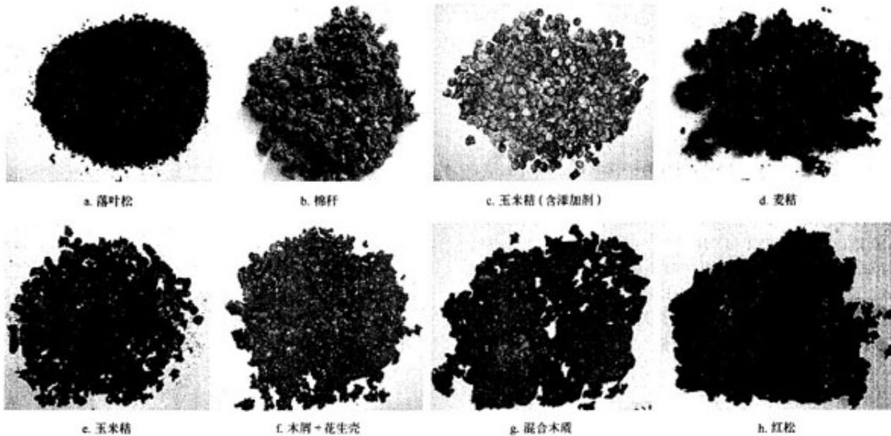
图6 各种生物质颗粒燃料灰渣形貌
