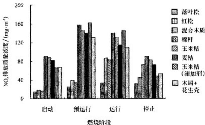
图5 各种生物质颗粒燃料 NO<sub>x</sub> 排放质量浓度
