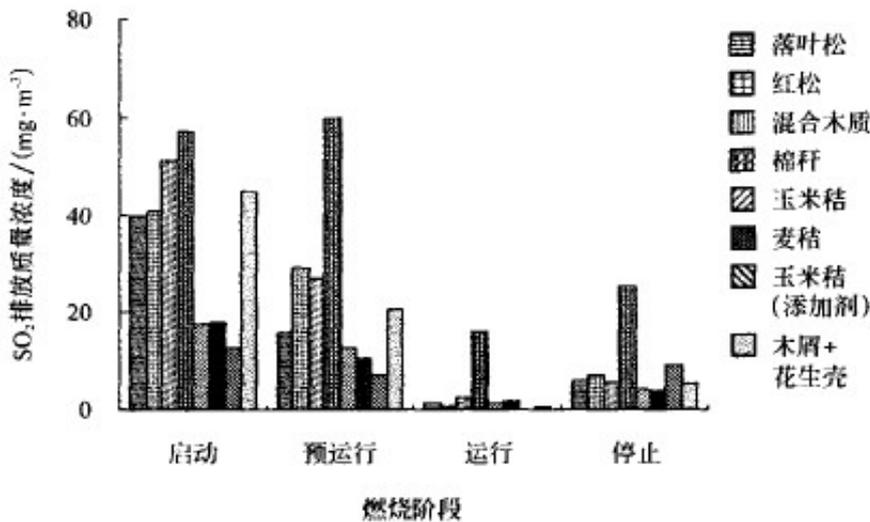
图4 各种生物质颗粒燃料 SO<sub>2</sub> 排放质量浓度
