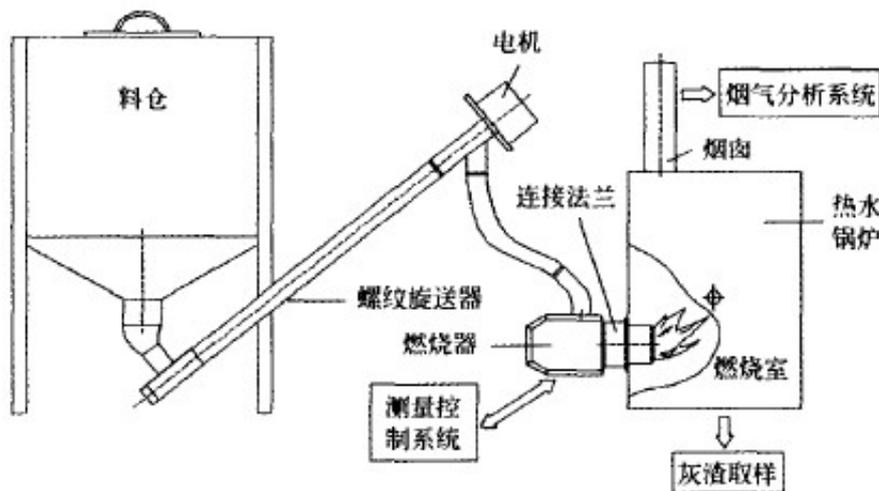
图 1 燃烧器试验系统示意图
