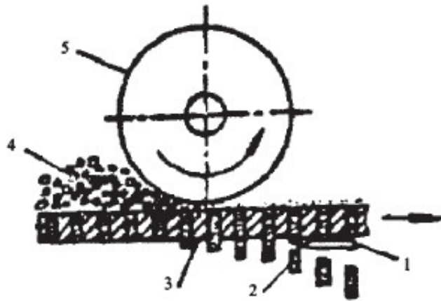
1. 切断刀具;2. 成型颗粒;3. 平模;4. 成型原料;5. 压轮
