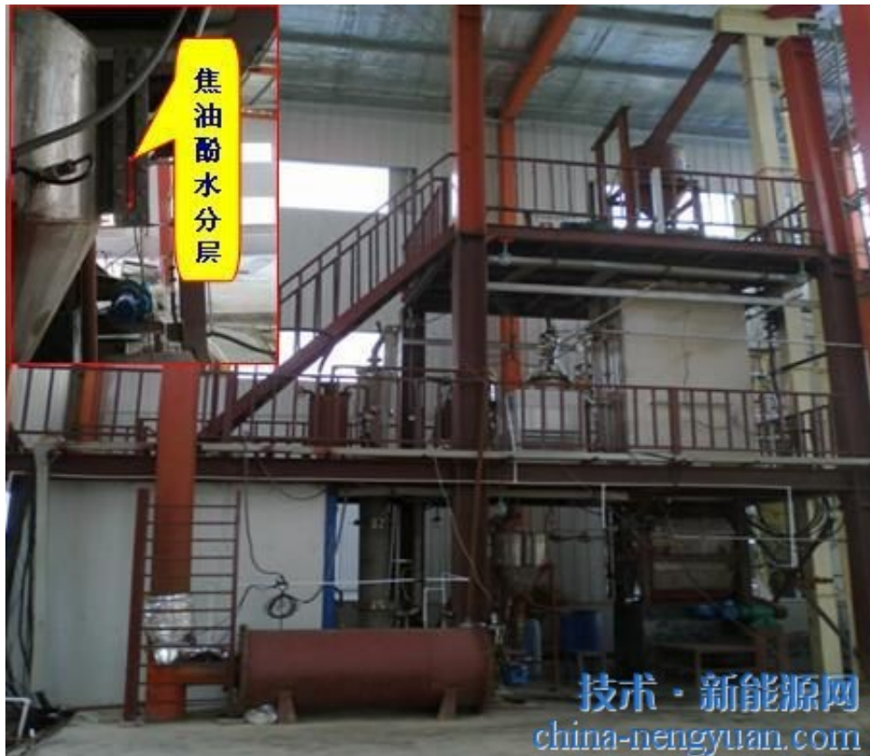
煤处理量1000吨/年气体热载体煤热解技术中试平台
