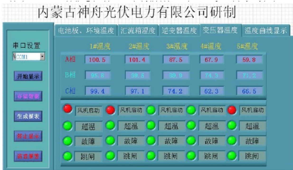
图6 变压器温控系统上位机显示界面
