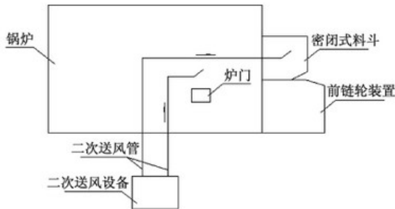
图2 二次送风设备安装示意图
