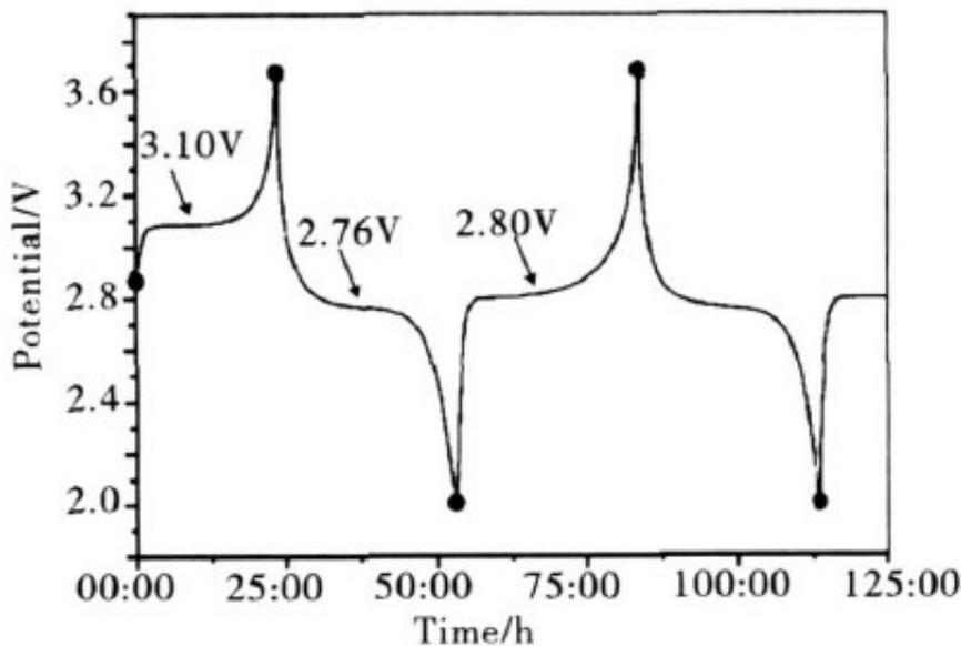
图 1  $\text{Li}_2\text{FeSiO}_4$  的充放电曲线<sup>[8]</sup>
