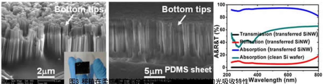
图3 移植在柔性基底上的硅纳米线阵列的光吸收特性
