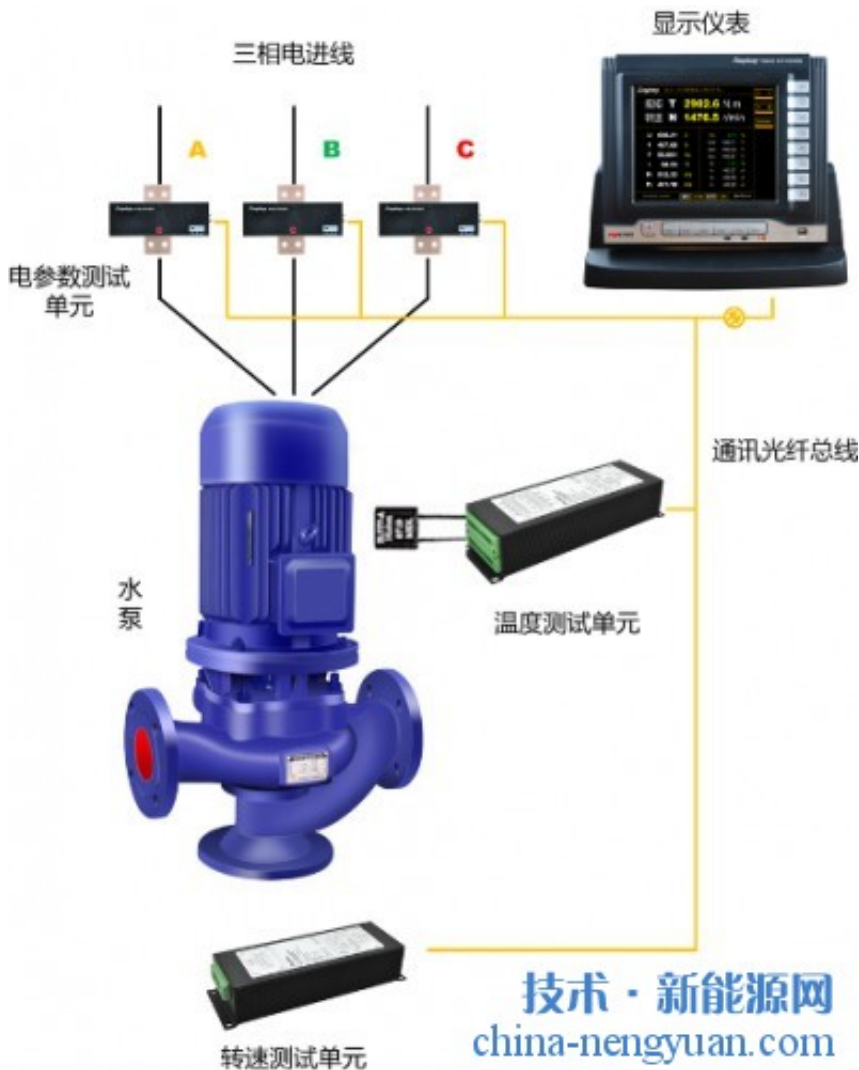
TN4000电子式扭矩仪构成原理
