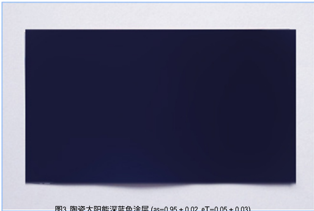
图3 陶瓷太阳能深蓝色涂层 ( as=0.95 \pm 0.02 , eT=0.05 \pm 0.03 )
