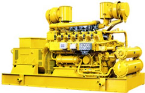
沼气热值一般在26MJ/立方；每标准立方沼气可发电2.3度电以上，耗气率为0.43 Nm<sup>3</sup>/kW.h。
