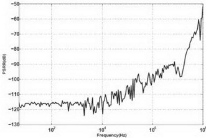
图3 电压基准源的电源抑制比测试结果
