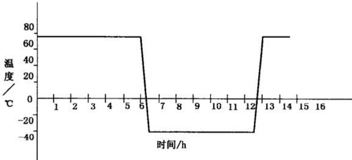
图 1 温度循环流程示意图
