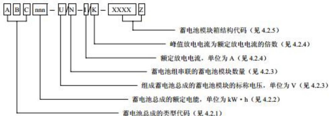
图 1 锂离子蓄电池总成产品型号表示方法
