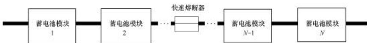
图3 快速熔断器安装位置
