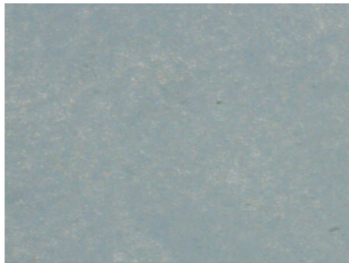
图 5 FFC-JW30 加速 SUV 1000 \text{ MJ/m}^2 老化后金相显微镜照片 ( \times 500 )
