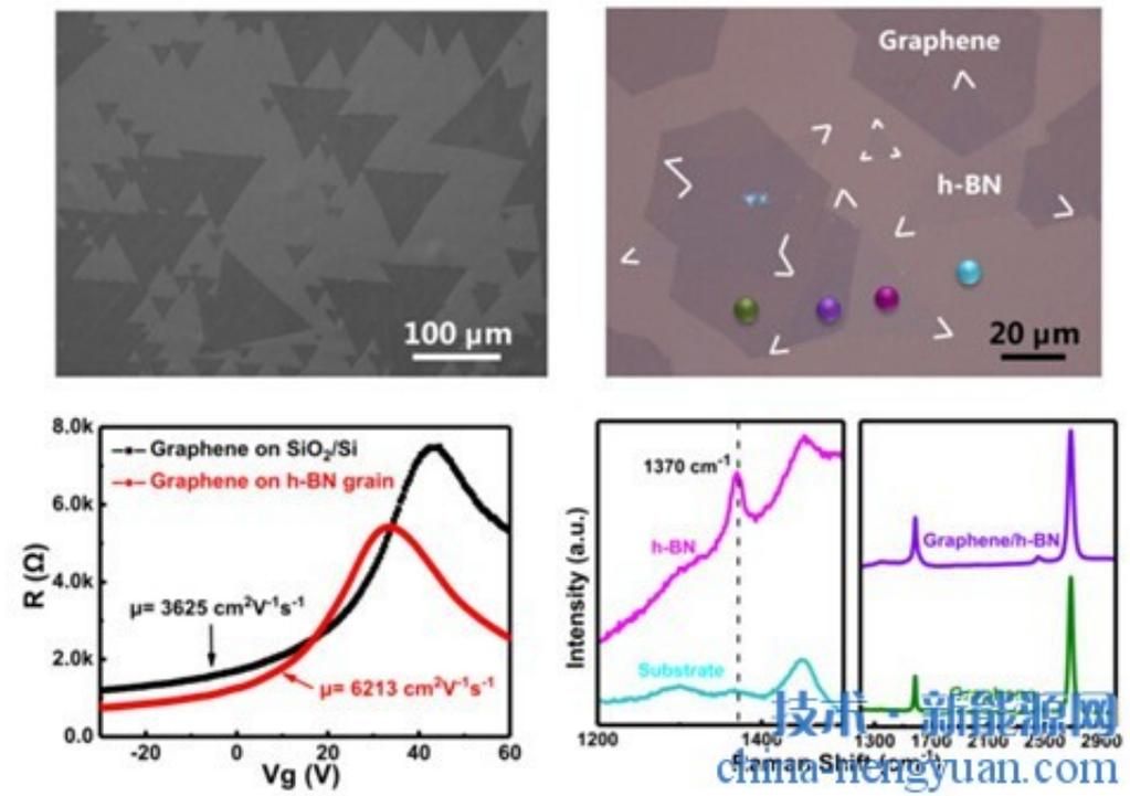
中国科学院上海微系统与信息技术研究所二维材料研究再获新进展。超导实验室、信息功能材料国家重点实验室的卢光远和吴天如等人采用化学气相沉积（CVD）方法，成功在铜镍合金衬底上制备出单层高质量六方氮化硼（h-BN）单晶畴，单晶面积较文献报道高出约2个数量级，研究论文Synthesis of large single-crystal hexagonal boron nitride grains on Cu-Ni alloy于1月21日在Nature Communications上发表(6:6160 doi: 10.1038/ncomms7160 (2015))。
