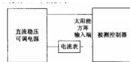
图8 空载损耗试验电路
