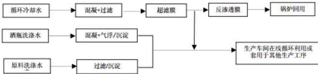
图3 低浓度工艺废水循环利用工艺流程图
