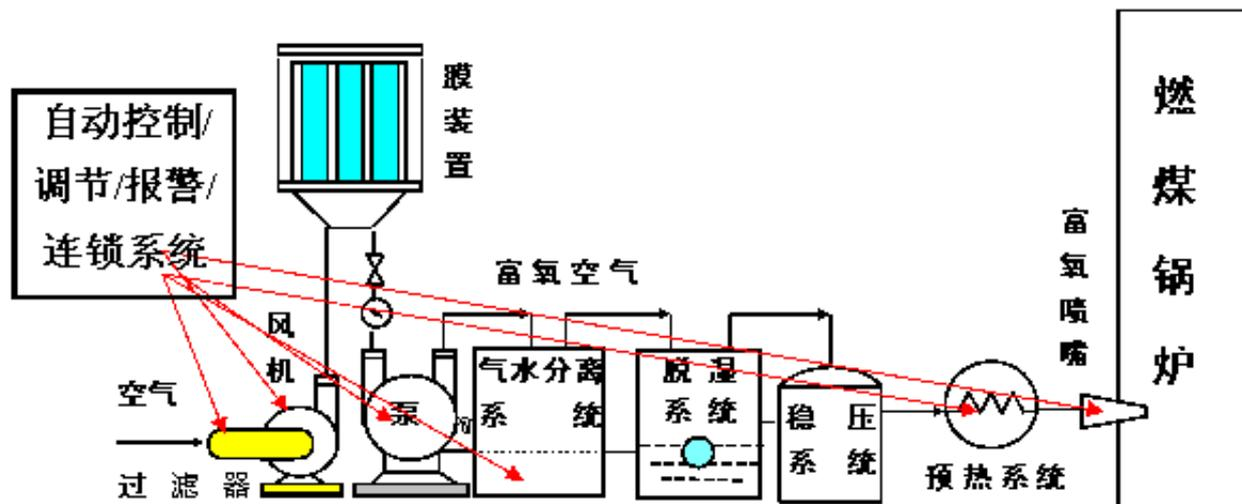
采用s型燃烧技术或型燃烧技术及四角燃烧，富氧喷嘴一般可以加在炉排底下、后拱、前拱、侧墙或四角等。目的是强化原有锅炉的火焰特性，使燃料和烟气在炉膛中的停留时间更长，从而充分彻底完全地燃烧，放出更多的有效热量。然后通过现场整体调节优化达到节能目的。
