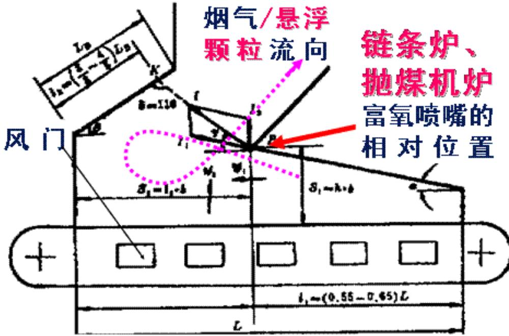
“α”形燃烧火焰动量计算示意图 (图1)
