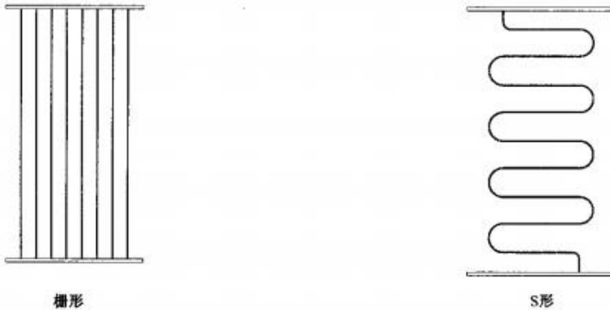
图 2 平板型太阳能集热器吸热体流道示意图
