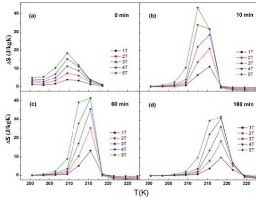
不同退火时间条带的磁熵变曲线
