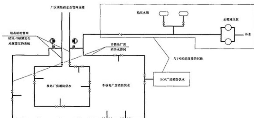
图 4 机组高压水分配管网
