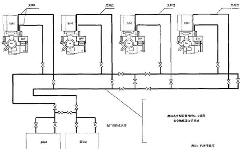
图 1 高压消防水分配原理图
