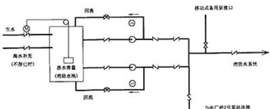
图 3 滨海厂址每台机组的消防供水系统原理图
