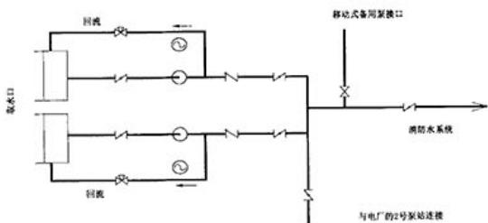
图 2 河边厂址每台机组的消防供水系统原理图
