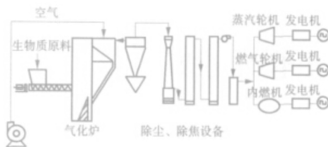
图1 生物质气化发电工艺流程示意图
