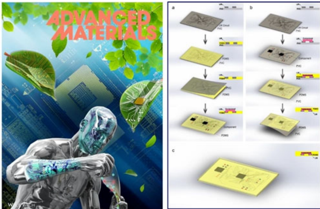
图1 《先进材料》背封面及用以制造适形化柔性功能电子的液态金属相变转印原理
