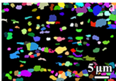
(a) EBSD图片，晶粒尺度1-5 \mu\text{m} 的再结晶晶粒层片分布于纳米晶基体(黑色衬度)；(b) “软-硬”层片微结构(HL)具有超细晶(UFG)的强度与粗晶(CG)的塑性；(c) “软-硬”层片微结构钛屈服强度和塑性的协同特性，综合力学性能比典型的钛合金还要优异。
