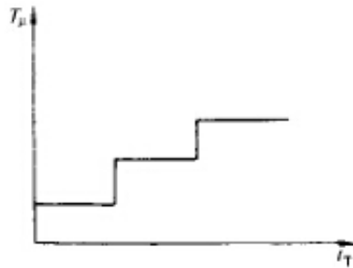
图3 阶梯加载方式的摩擦转矩曲线
