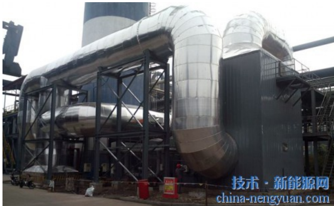
焦炉烟气低温脱硝工业示范装置
