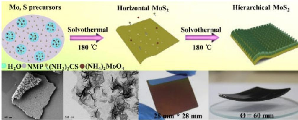
图1 多种基底上原位生长大尺寸、具有多级结构的MoS<sub>2</sub>纳米薄膜
