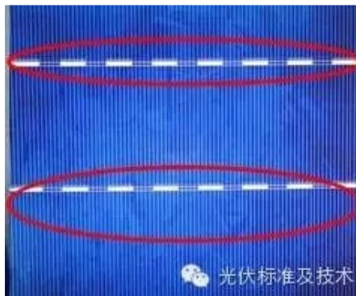
图2电池片虚印不良
