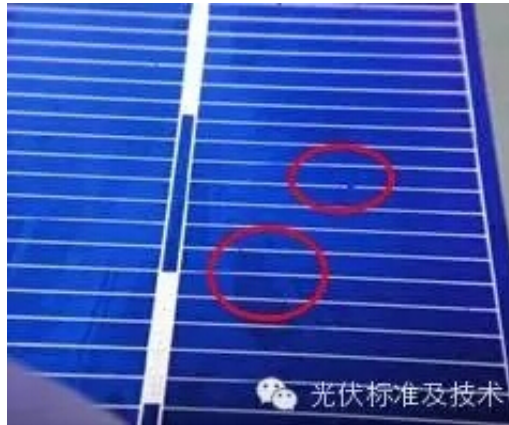
图1电池片断栅不良
