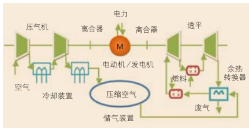
图9 燃烧燃料的非绝热压缩空气储能（带回热）
