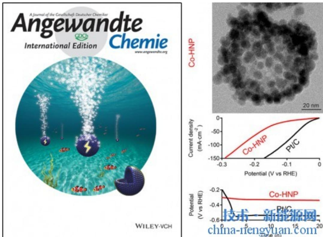
近日，中国科学技术大学教授马明明课题组设计了一种由钴纳米晶自组装形成的纳米空心球，可以作为催化剂在中性水溶液中高效地催化电解水产生氢气，并且可以在大电流密度下长时间稳定工作。该研究成果在线发表在 *Angew. Chem. Int. Ed.* (doi:10.1002/anie.201601367) 上，并被选为内封面。论文的第一作者是课题组博士生刘炳瑞。
