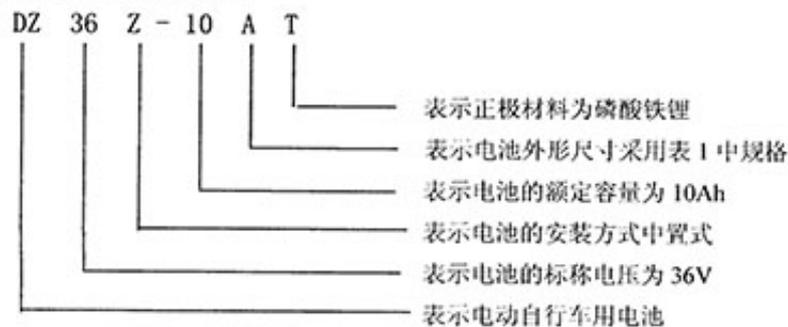
示例2: 采用后置式安装方式, 标称电压 48V, 额定容量 12Ah, 采用三元材料作为正极材料, 电池外形尺寸为 390×170×80 的锂离子电池型号命名。
