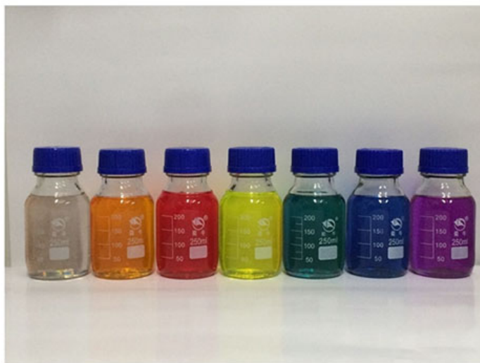
图4 可印刷半导体碳纳米管墨水
