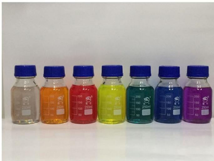
图4 可印刷半导体碳纳米管墨水
