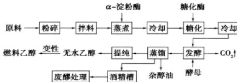
图1 淀粉质发酵法制备燃料乙醇工艺流程图
