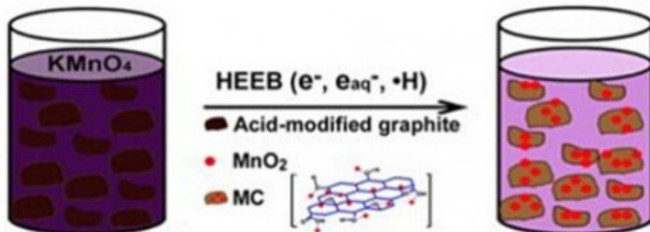
图1：光催化剂MnO<sub>2</sub>/C的合成过程
