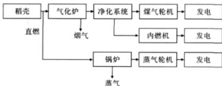
图 1 稻壳发电技术路线
