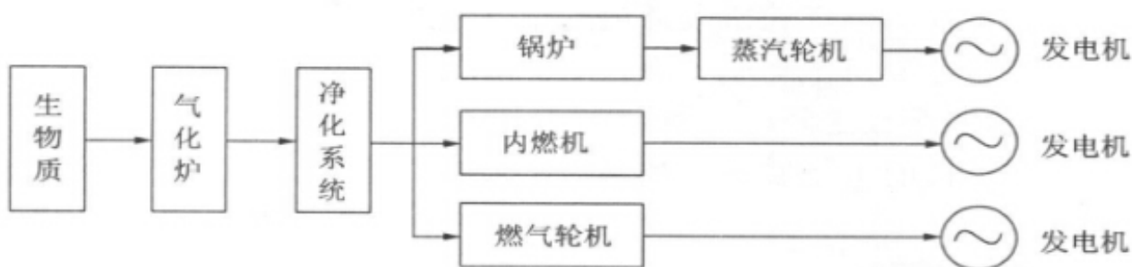
图 1 生物质气化发电方式
