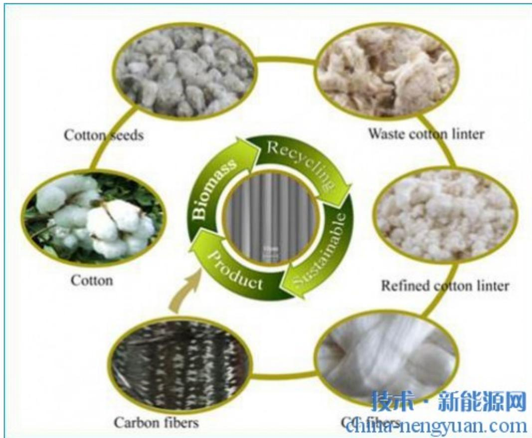
碳纤维作为一种高性能纤维材料广泛应用于航空、体育行业等领域。传统制备碳纤维的方法是以石化能源如聚丙烯腈、中间相沥青为原料，但由于化石能源的不可再生性以及制备碳纤维过程中会产生污染物（如制备PAN基碳纤维过程中会产生氰化氢有毒气体），从而污染环境。因此，以可再生、无毒害的天然资源为原料，开发环保、低成本的制备碳纤维的工艺具有十分重要的意义。
