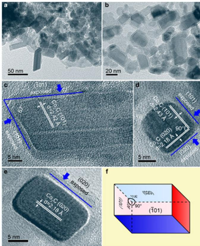
图1 FTO催化剂TEM照片。a、b为低倍TEM照片；c、d、e为高倍TEM照片；f为 $\text{Co}_2\text{C}$ 平行六面体纳米颗粒示意图。
